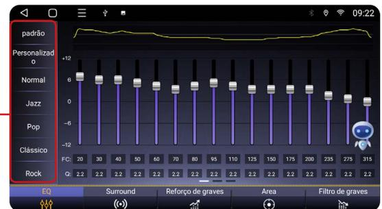
O aplicativo equalizador disponibiliza 8 faixas de equalização pré-definidas e, também permite ajustar a frequência na forma desejada. Basta mover na linha de opções para visualizar as opções pré-definidas.
