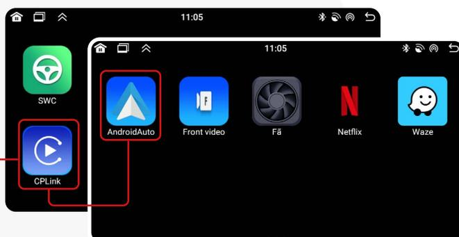
Para conectar o iPhone à central multimídia, primeiro é necessário ativar o Bluetooth e, em seguida, conectar o telefone à central multimídia usando o cabo USB. Em seguida, na central multimídia, clique no ícone CPlink e aceite a notificação que aparecerá no seu celular. O iPhone se conectará automaticamente à central multimídia e você poderá usar os aplicativos.
