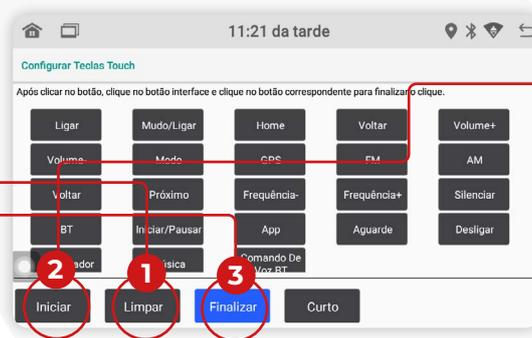
Depois clique em iniciar, na função que deseja gravar no painel do i-Tablet, após isso clique a tecla do touch que deseja gravar, repita o processo com as outras teclas.
