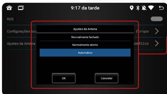
**3.6.5.1. NORMALMENTE FECHADO:** Quando selecionar esta função a saída de alimentação 12VDC da antena permanece desativada.
