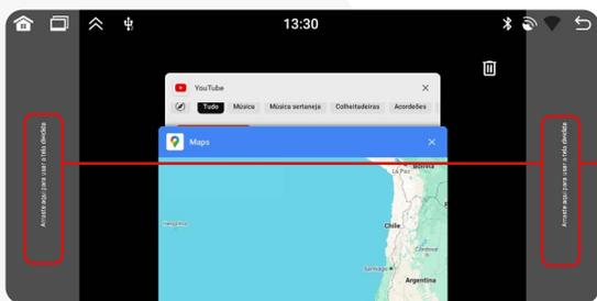
**2** Em seguida clique por três segundos na primeira atividade que deseja utilizar e arraste para “utilizar ecrã dividido”.
