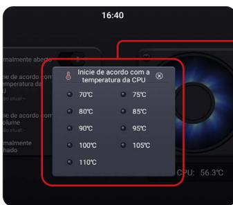
Com a opção **“Inicie de acordo com a temperatura da CPU”** ativada, a ventoinha será acionada automaticamente quando a temperatura do processador atingir o limite predefinido.
