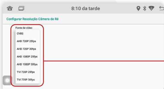
A configuração da câmera de ré é essencial para garantir uma imagem nítida e de alta qualidade durante a visualização. Recomenda-se configurar a função como CVBS para garantir o bom funcionamento da câmera de ré.
